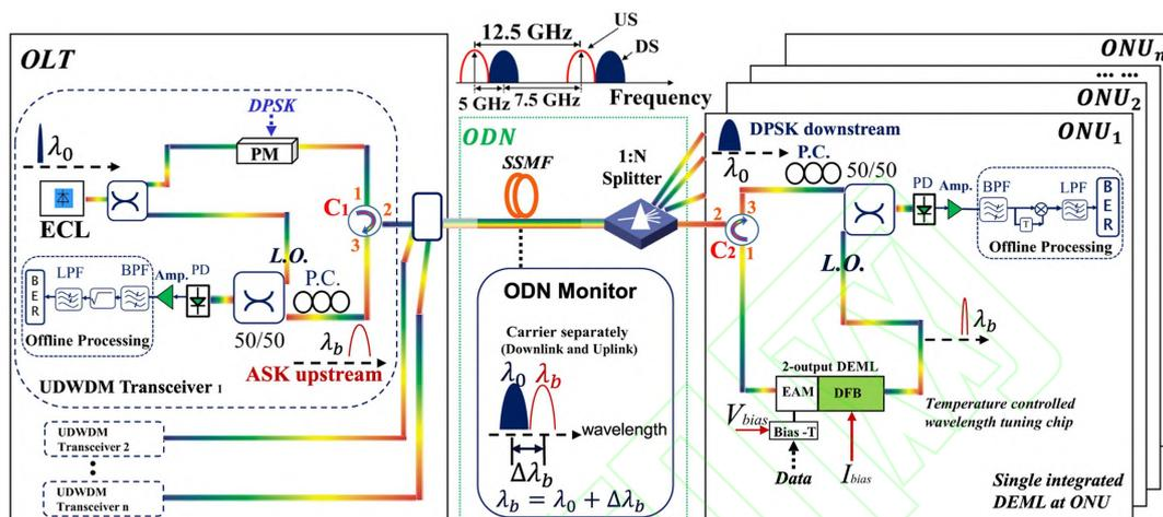
图 9 利用 DEML 完成 UDWDM-PON 双向传输<sup>[20]</sup>
