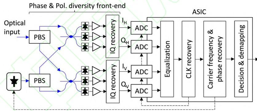
图 7 Tabares 等人提出的偏振分集相干接收机<sup>[17]</sup>
