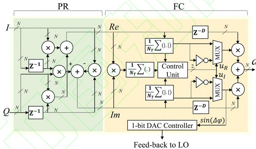
图 11 无需 LUT 的载波恢复算法<sup>[32]</sup>
