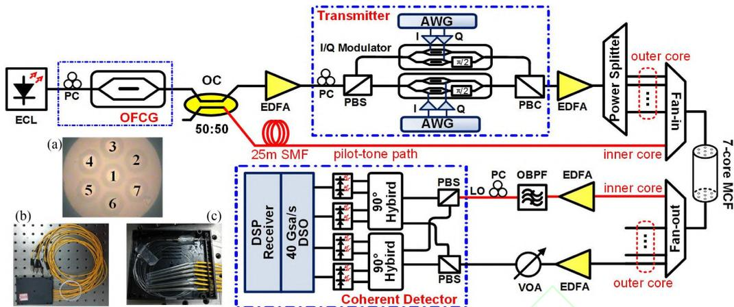
图 2 采用七芯光纤传输的 UDWDM-PON<sup>[11]</sup>
