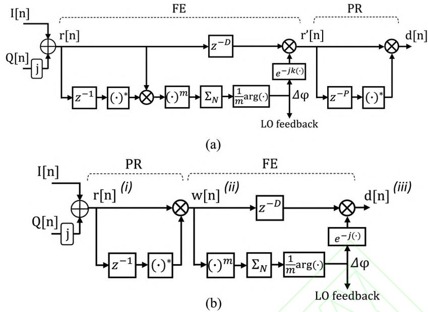
图 10 (a) 传统的载波恢复算法 (b) 简化的载波恢复算法<sup>[30]</sup>
