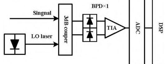
图5 使用一个 BPD 的简化相干接收机结构图
