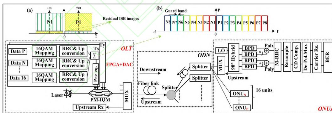
图 1 使用 Nyquist-ISB 调制的 UDWDM-PON 原理图<sup>[7]</sup>
