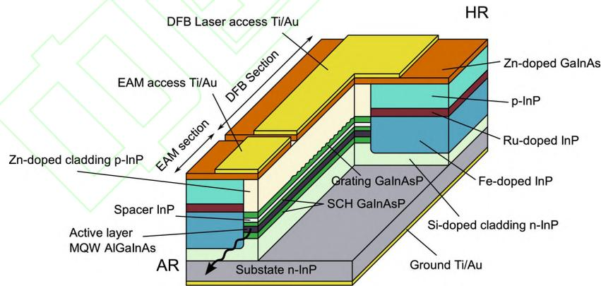
图 8 双电吸收调制器 (DEML) 模型<sup>[19]</sup>
